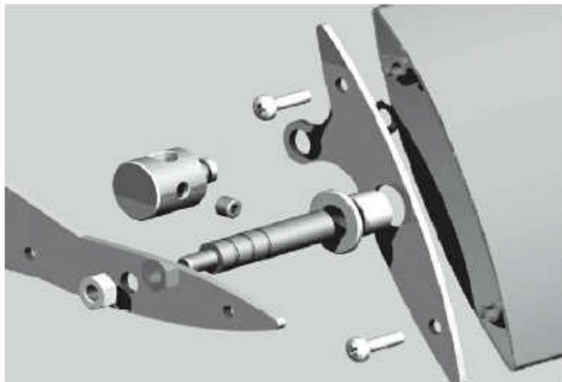
Tapas laterales para sujeción a perfil y colocación del mecanismo de accionamiento:
